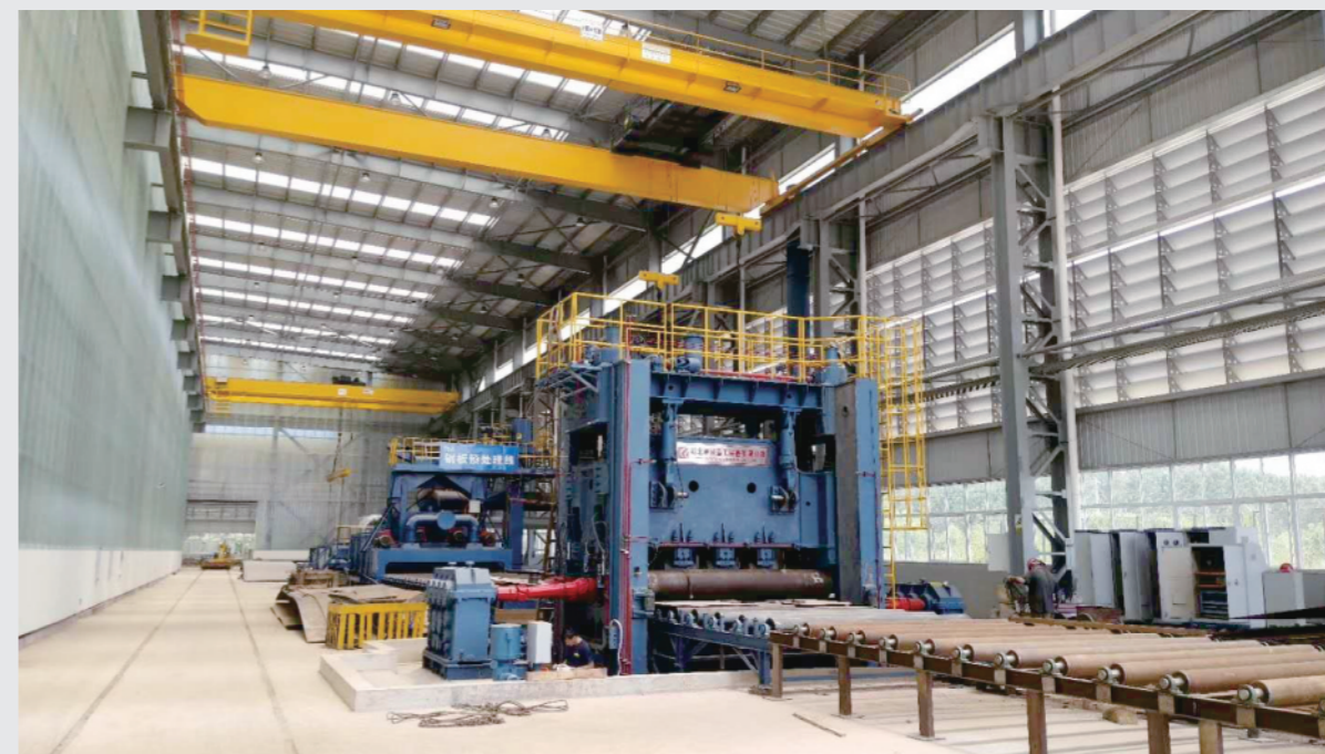
武汉海波钢构W43-32×3600七辊校平机,主要是桥梁钢结构的校平和消除内应力
